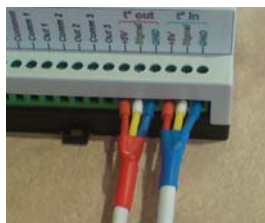
свързване на датчици с 3 извода за температури до 99 градуса
